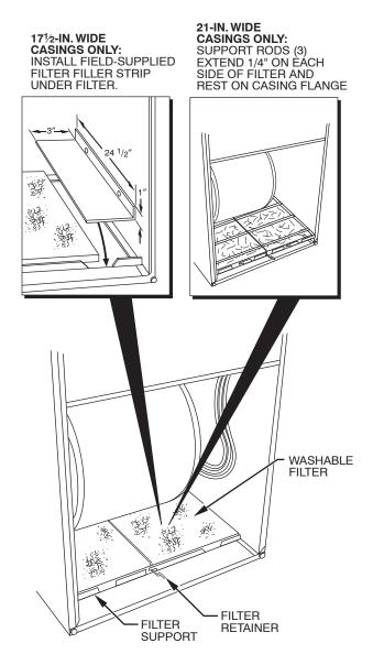
Fig. 24—Bottom Filter Arrangement
